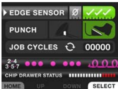
Figura 14. Pantalla Home (Principal) con el sensor de bordes y el pedal activados.
