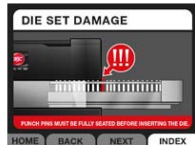
Figure 22. Écran Endommagement du bloc à colonne.
